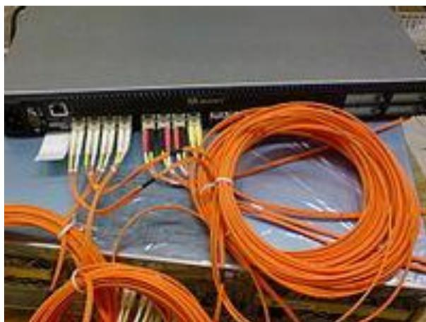
*Рис..1 SAN-Свитч Qlogic SANbox 5600 с подключёнными к нему оптическими разъёмами Fibre Channel*
