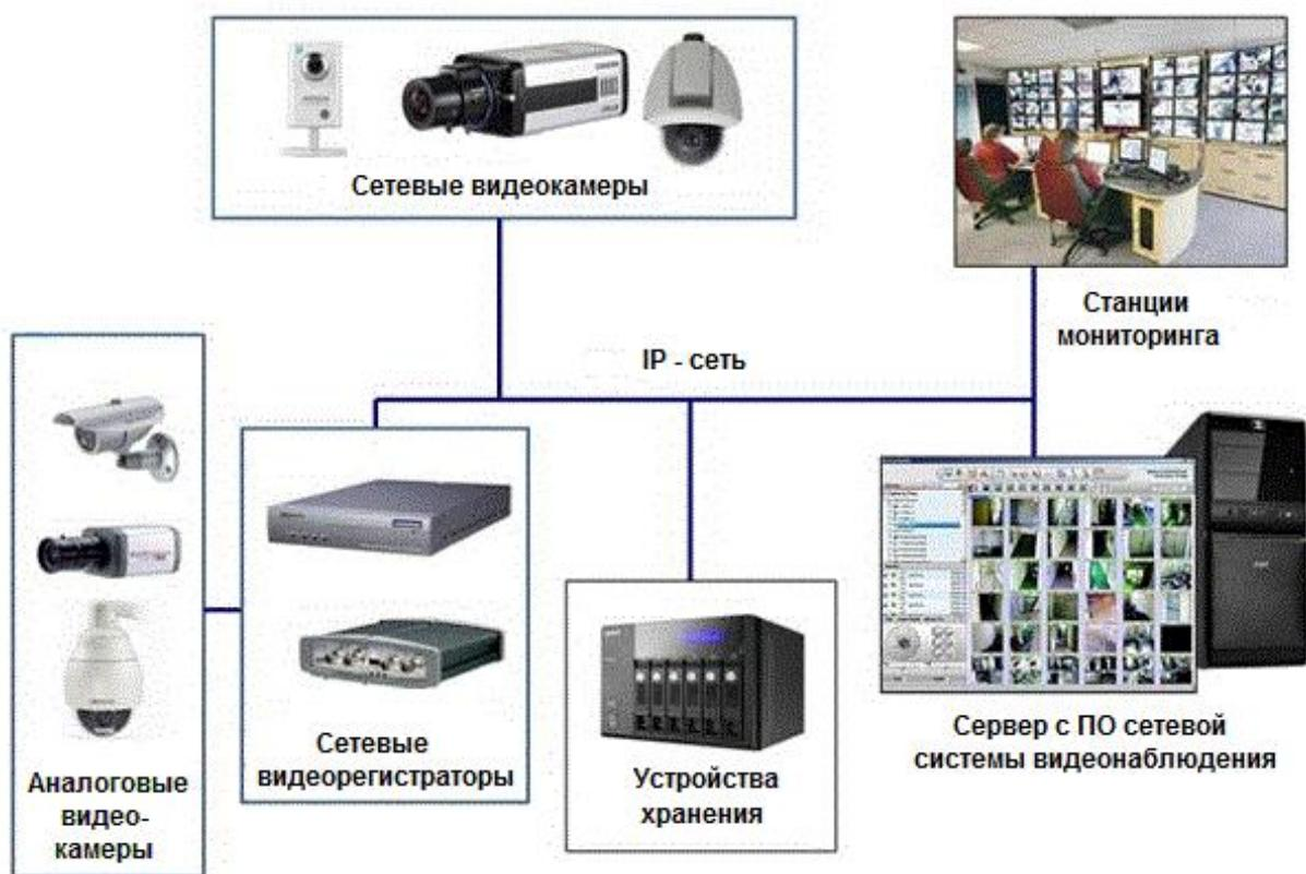
Рис. 6.2. Структурная схема сетевой системы видеонаблюдения.
