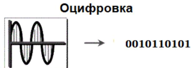
Рис. 3.3. Оцифровка голосового сигнала
