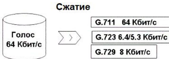
Рис. 3.4. Сжатие канала
